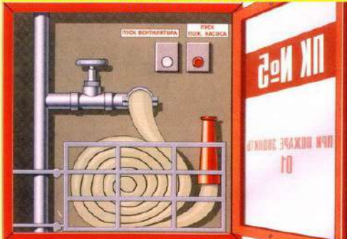
ВНУТРЕННИЙ ПОЖАРНЫЙ КРАН
